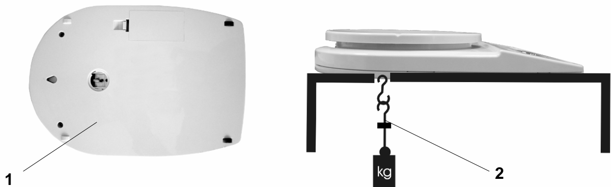
Kuva 1: Vaa'an asetus lattianalaiseen punnitukseen (2).
